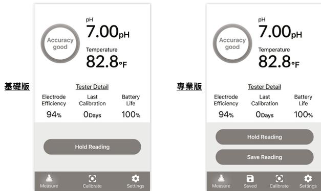
在此介面可以點擊”Hold Reading”鎖定(解鎖)測量資料, 點擊”Save Reading”存儲測量資料, 所存儲的資料可以點擊”Saved”查看。
